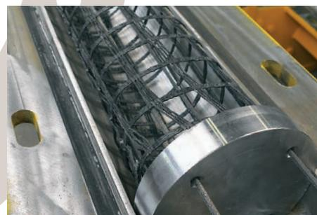
Armierung eines 4.2 Meter langen Carbolith® - Lichtmastes.
